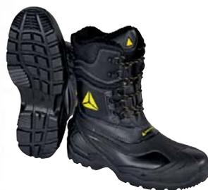
Stivali di sicurezza. Tomaia : PU e Poliestere. Fodera : membrana poliestere impermeabile DELTA-TEX™ e imbottita SNOWTEX™ + collo poliestere imbottito. Soletta di pulizia: Staccabile preformata - Feltro. Suola: iniettata - PU doppia densità resistente a -30°C. Stivale amagnetico.
