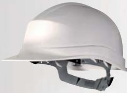
Elmetto da cantiere polipropilene (PP) o polietilene alta densità (HDPE), trattato anti-UV. Cuffia polietilene (LDPE), con 8 punti di fissaggio. Frontalino spugna. Chiusura a fibbia regolabile: girotesta da 53 a 63 cm. Elmetto dielettrico (isolamento fino a 1000 VAC o 1500 VCC). Foro standard per accessori. Punti di ancoraggio per sottogola a 2 o a 4 punti.
